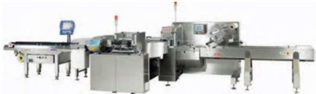
شکل ۵۵- ماشین بسته‌بندی به روش اتمسفر اصلاح شده
