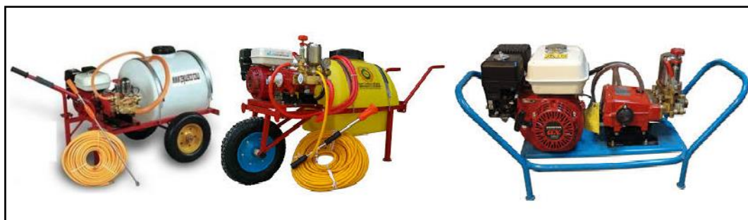
شکل ۴۱- سمپاش موتوری بدون چرخ (زنبه‌ای) و چرخ‌دار
