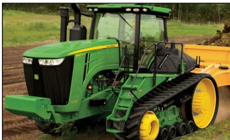
شکل ۲- تراکتور مجهز به چرخ شنی‌دار لاستیکی
